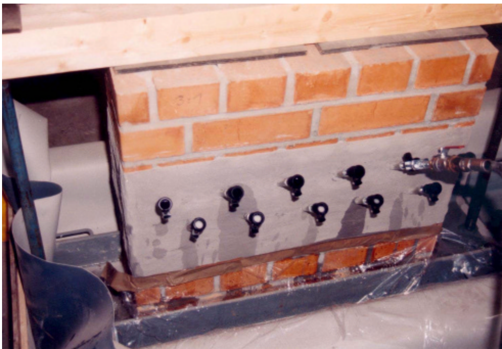
Bild 2: Gelinjektion in einen Mauerwerksprobekörper mit Umgebungsfeuchte
