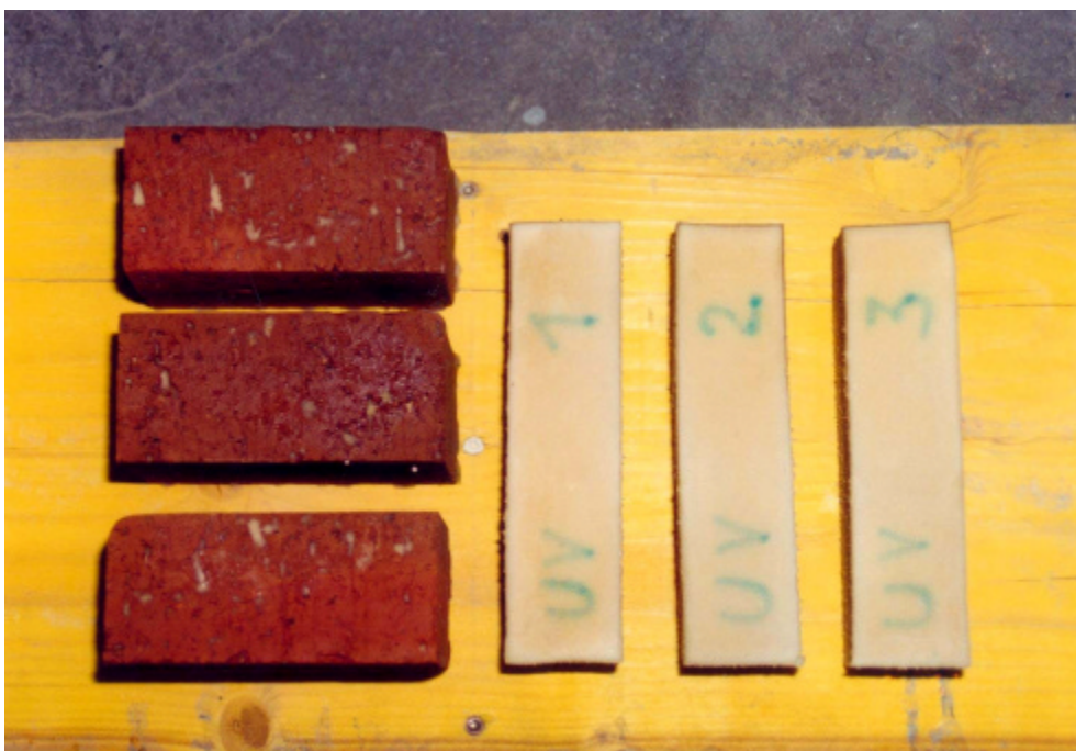
Bild 4: Gelprismen und gelgetränkte Ziegel nach zehnmonatiger Lagerung in Wasser
