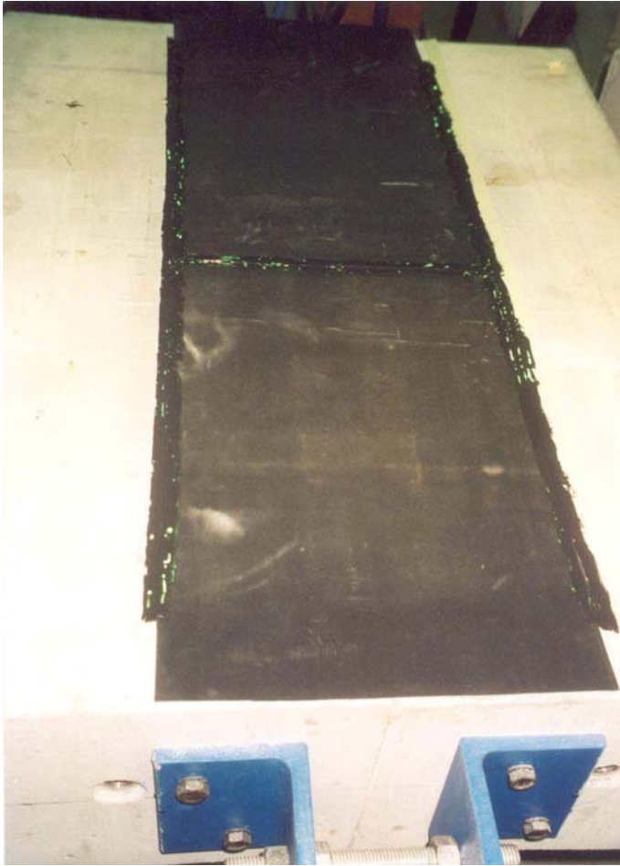
Bild 5: Fertig appliziertes GETIFIX FD-System mit Überlappungsstoß und Randversiegelung, Folienbreite 30 cm
