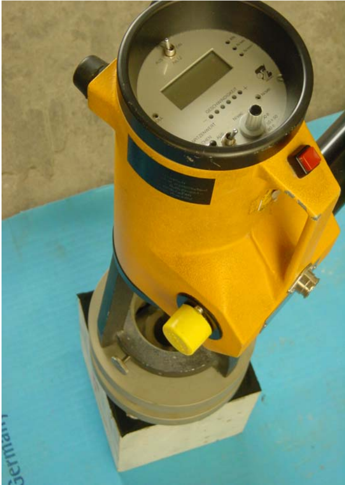
Bild 1: Prüfung des Haftverbundes des GETIFIX FD-Systems auf einem Betonuntergrund
