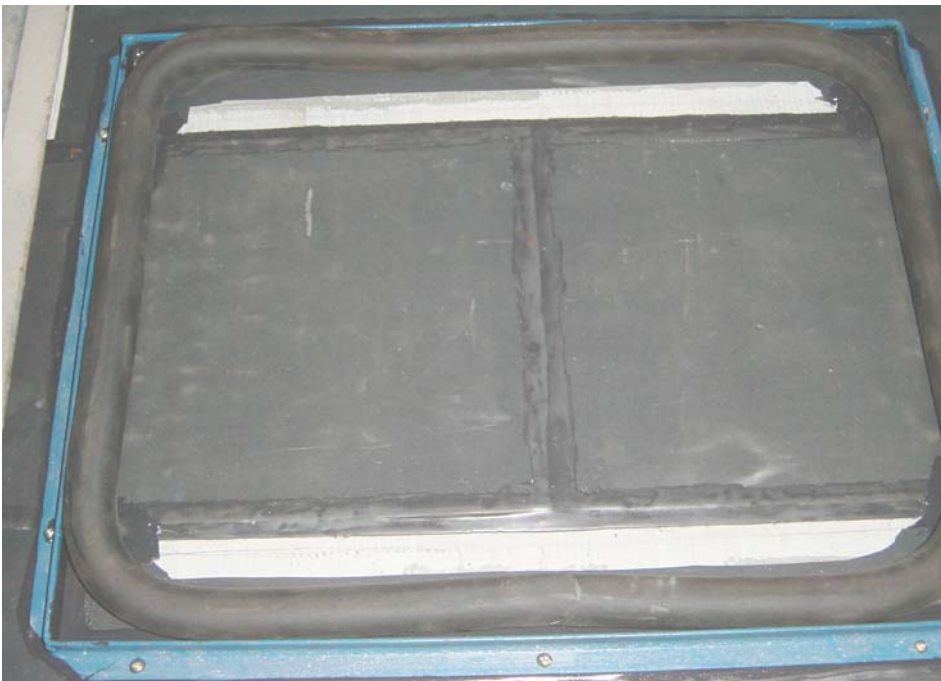
Bild 6: GETIFIX FD-System (Folienbreite 50 cm) über der Arbeitsfuge des Dichtigkeitsprobekörpers vor Beginn der Dichtigkeitsprüfung, Ränder werden in die Prüfung mit einbezogen
